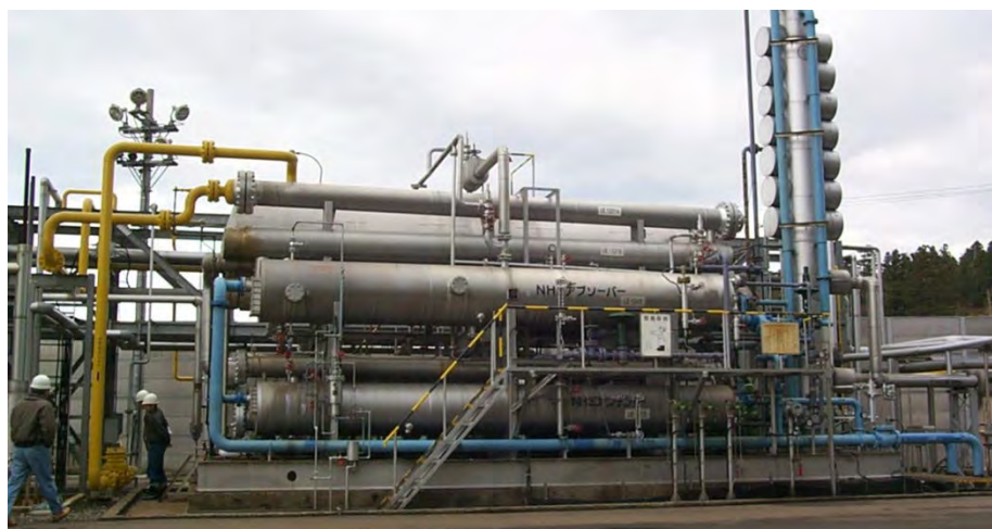
図 3.7.18 筆者撮影のアンモニア吸収冷凍式低温分離装置、1998
