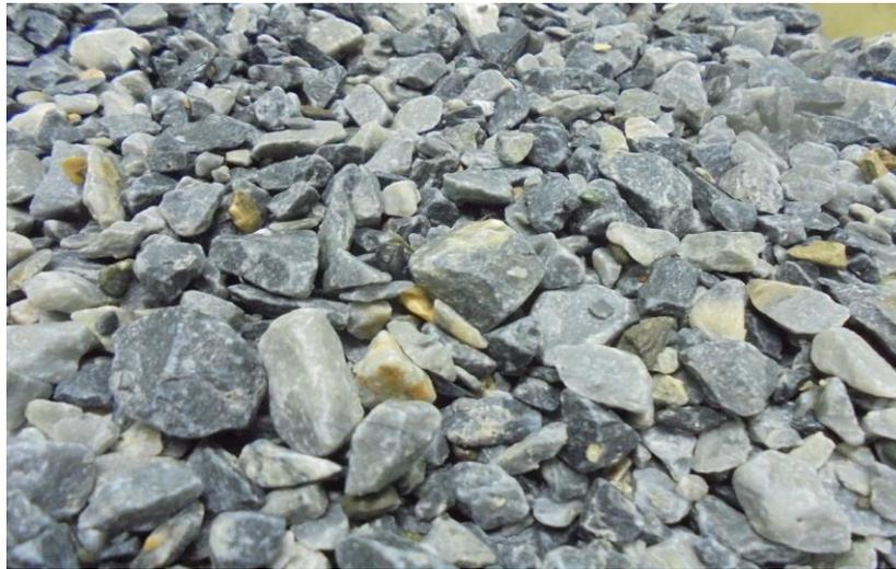
回収粗骨材の例
