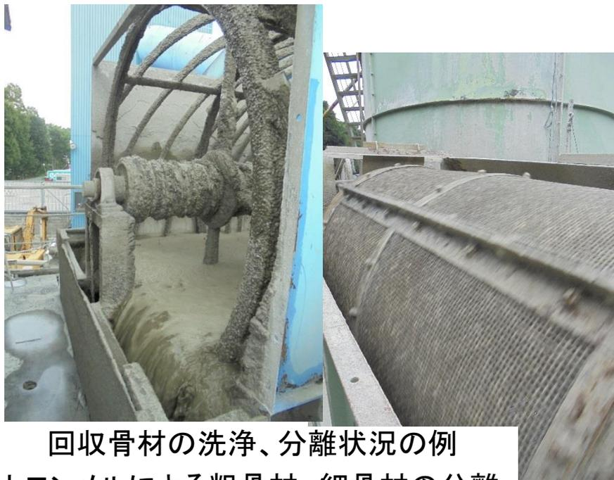
回収骨材の洗浄、分離状況の例
