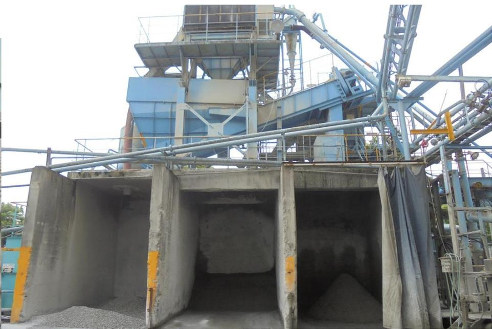
回収骨材の洗浄、分離装置とストックヤードの例
