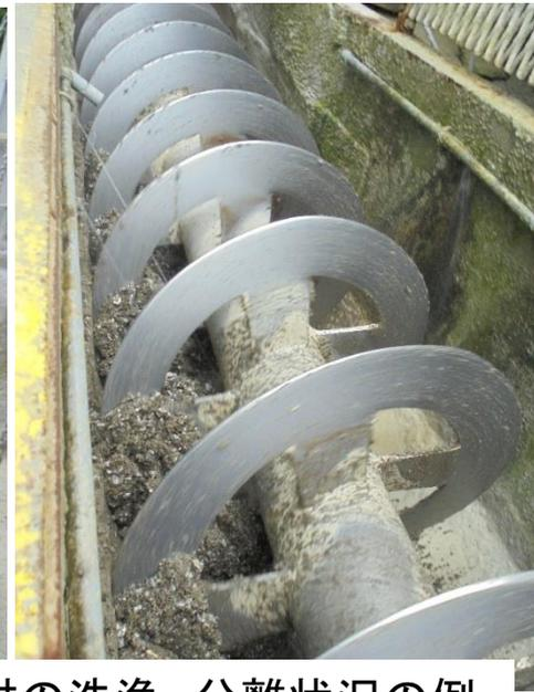
洗車場からの回収骨材の洗浄、分離状況の例
