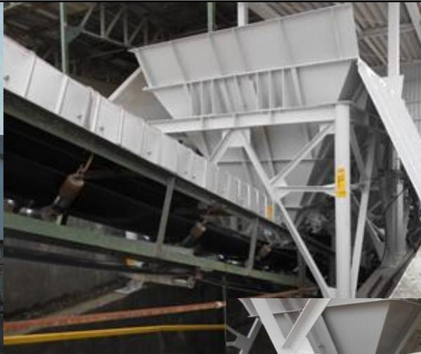
A法の工場では、ベルトコンベア上に、回収骨材混入装置(例)などを設置するなどの工夫をすると、均一に混入できる。
