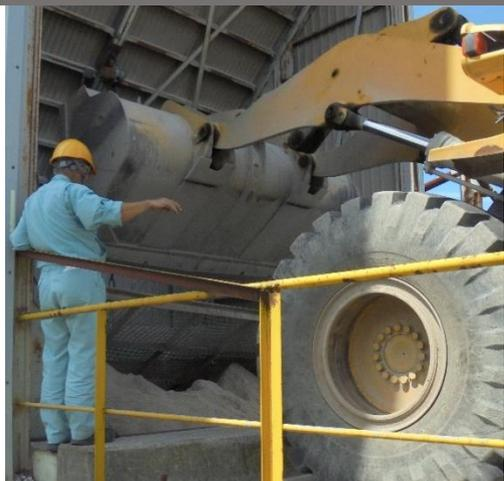
A法の場合には、回収骨材をグランドホッパーなどに投入する。その際には、**回収骨材が偏らないように工夫する。**
