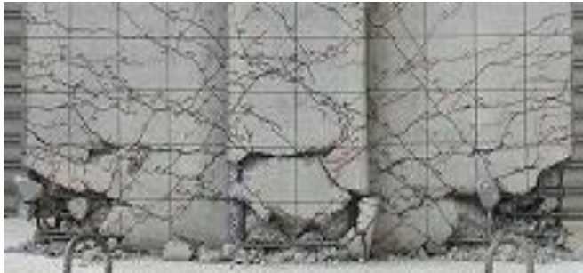
梁端部最終破壊状況
