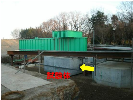
水平載荷試験状況
