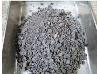
浚渫土改質材は、転炉にて鋼を製造する工程で生成する転炉系製鋼スラグを成分管理と粒度調整した材料であり、軟弱浚渫土と混合して利用されるもの。本ガイドラインは、浚渫土改質材の一つである加7改質材について、評価を行った。
