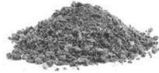
石炭火力発電所で石炭を微粉灰ボイラーで燃焼させ、その燃焼により発生した石炭灰がボイラー炉内で熔融し、炉壁に付着したものが水張りした炉底に落下し冷却される。この塊をクラッシャーで粉碎し、粒度を調整して製造されるもの。
