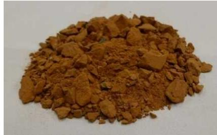
瓦工場より発生した規格外瓦を破碎し、利用用途に応じた粒度に調整を行ったもの。
