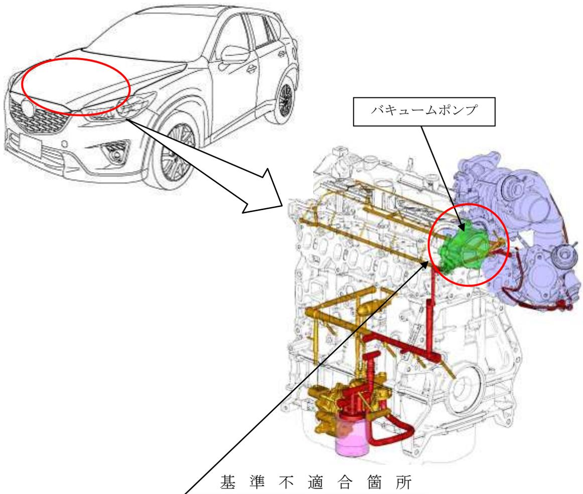
ディーゼルエンジン車のバキュームポンプにおいて、ポンプ軸の耐摩耗性が不十分なため、エンジン内部で発生する金属粉により当該軸が摩耗することがある。そのため、そのまま使用を続けると軸の摩耗が進み、負圧生成能力が低下し、エンジン低回転時にブレーキペダルを短時間に複数回踏むと、一時的にブレーキアシスト力が低下するおそれがある。
