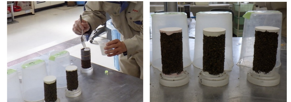
供試体の載荷面のキャッピングの例
