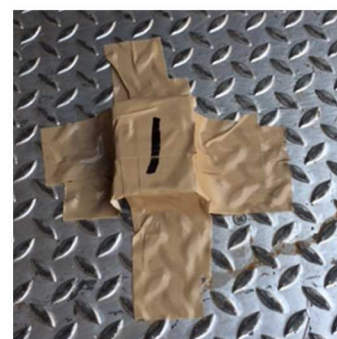
図1 振動計測機取付け要領
