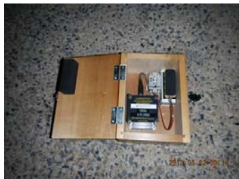
振動計設置場所(コンテナ内後部)
