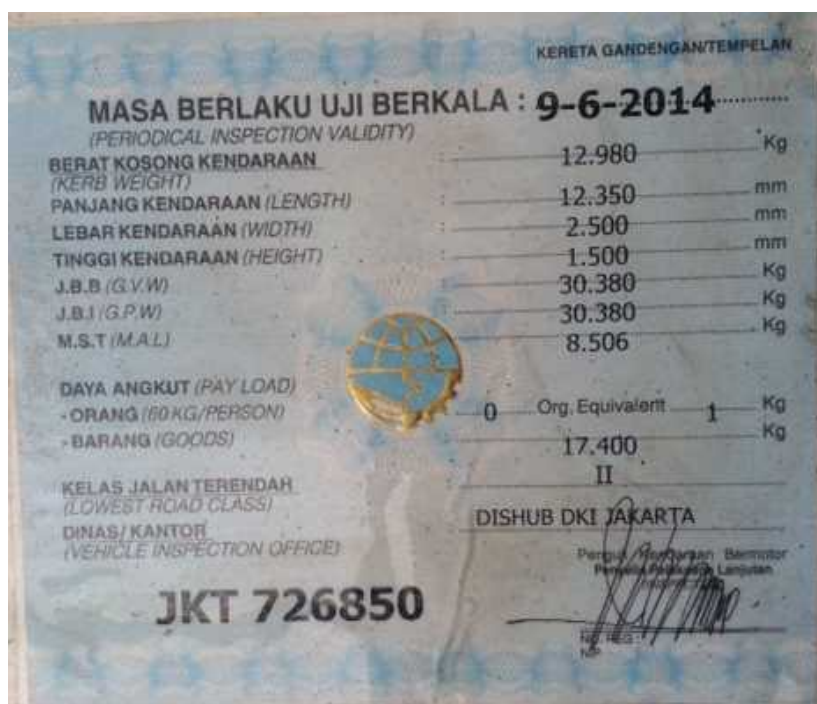
図 3-8 インドネシアシャーシの車体貼付用車検証ステッカー
