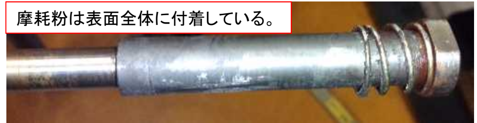
写真1 事故機のプランジャー押しボルト
