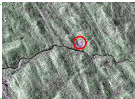
SAR画像（5月30日観測） 一時期多偏波カラー合成画像から 土砂移動のおそれのある箇所を抽出
