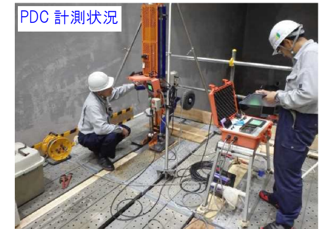
人工模型地盤に対するPDC実験状況 (ドラム缶土槽)
