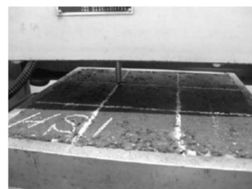
写真-4 静荷重載荷試験状況
