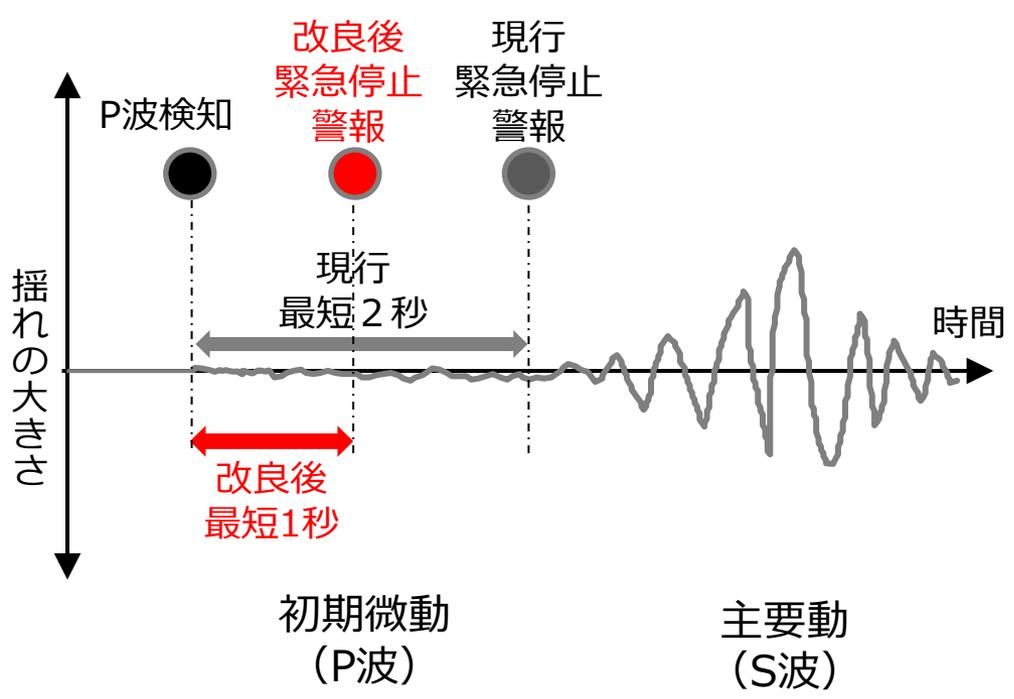
初期微動 (P波) 検知後に地震情報 (地震の位置や規模) を推定し、必要な区間に緊急停止警報を発報
