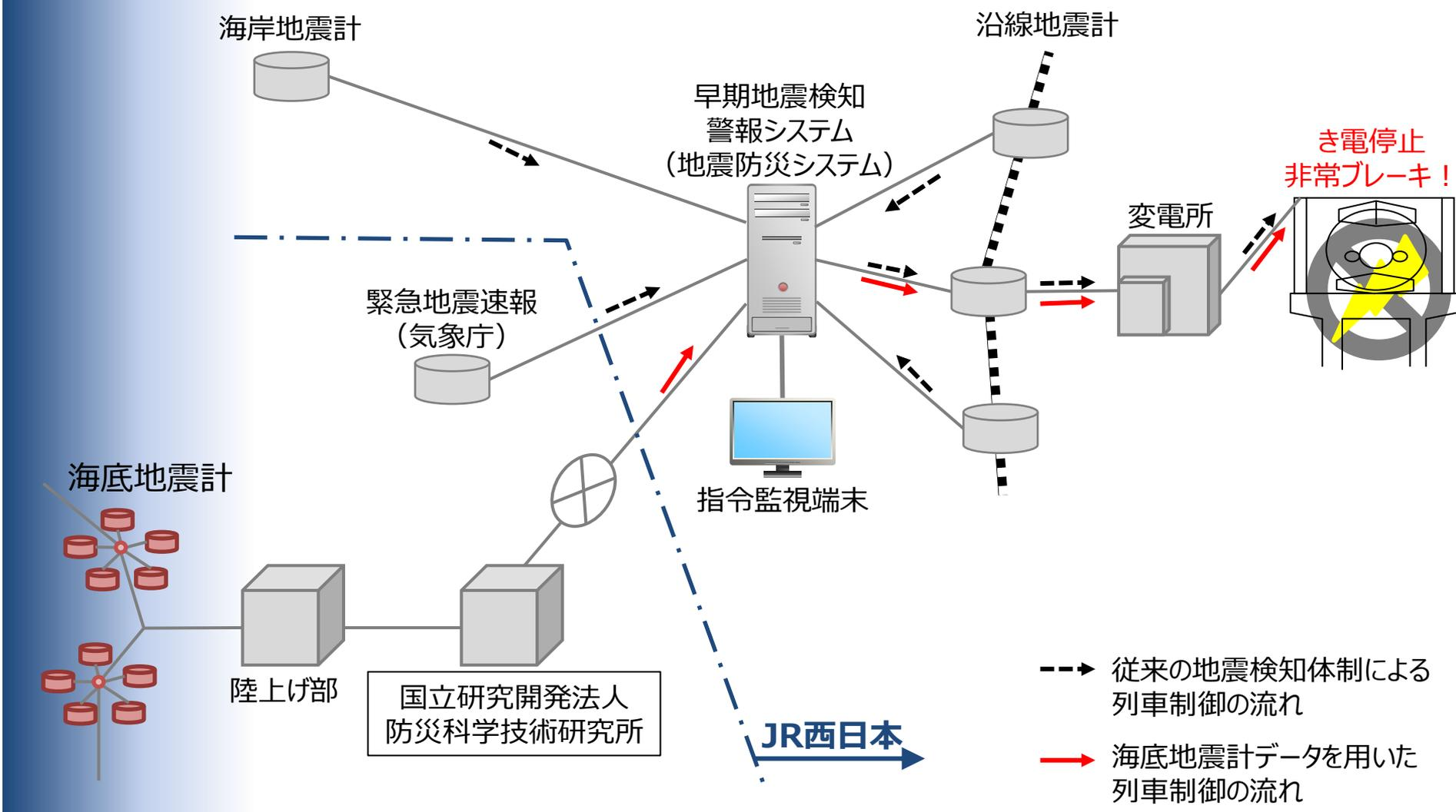
**海岸地震計における地震検知と比べて、最大約10秒の検知時間短縮**
