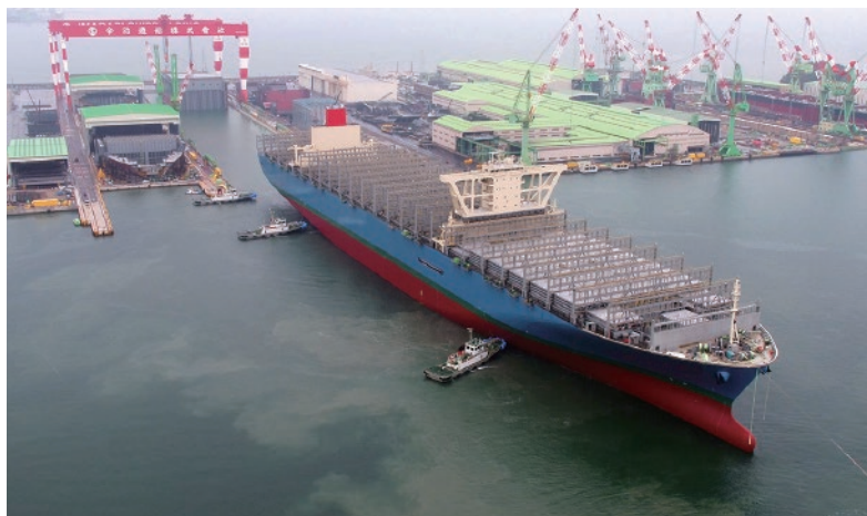
新ドック完成と同時に進水する長さ400mの20000個積みコンテナ船
