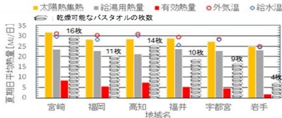
図2 太陽熱集熱量および有効熱量
