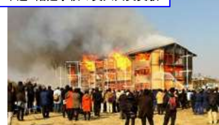
木造3階建て学校の実大火災実験
