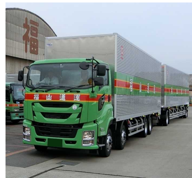
走行中のダブル連結トラック（25m車両）
