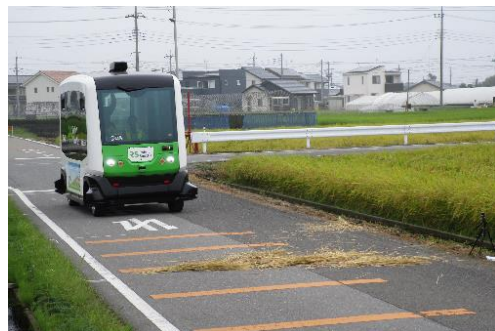
路面の落下物や障害物を再現し、自動運転に必要な道路の管理水準を検証
