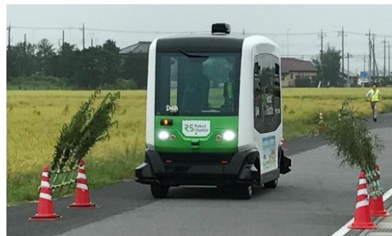
路面の落下物や障害物を再現し、自動運転に必要な道路の管理水準を検証
