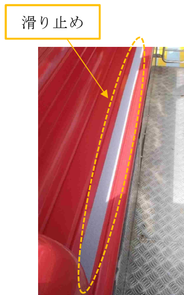
写真22 座席部分への滑り止め設置
