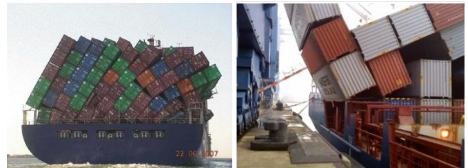
コンテナ荷崩れの事例
