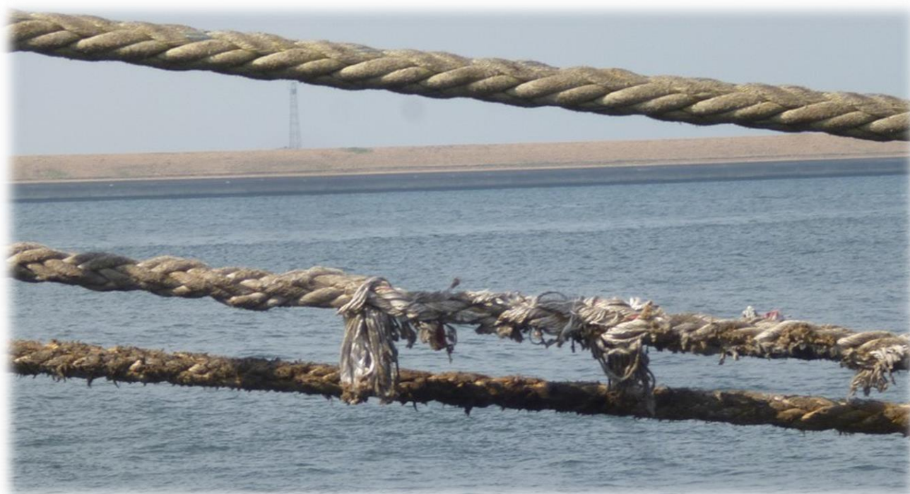
< 著しい損傷の事例 >
