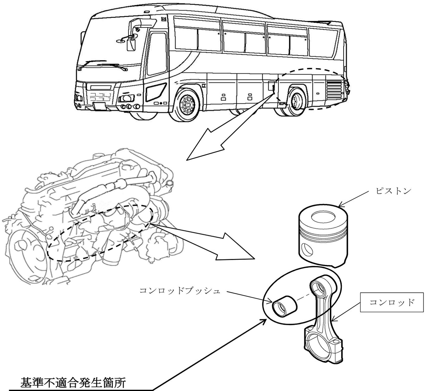
バスのエンジンにおいて、コンロッドブッシュ挿入時の製造条件が不適切なため、ブッシュの保持力が不足しているものがある。そのため、そのまま使用を続けると、当該ブッシュが摩耗、損傷することで異音が発生し、最悪の場合、エンジンが破損して走行できなくなるおそれがある。
