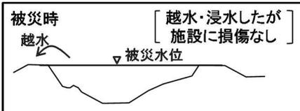
堤防の損傷はなかつたが、越水・浸水したことから、河道拡幅等を実施
