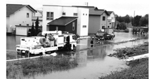
排水ポンプ車 緊急排水作業（音更町）
