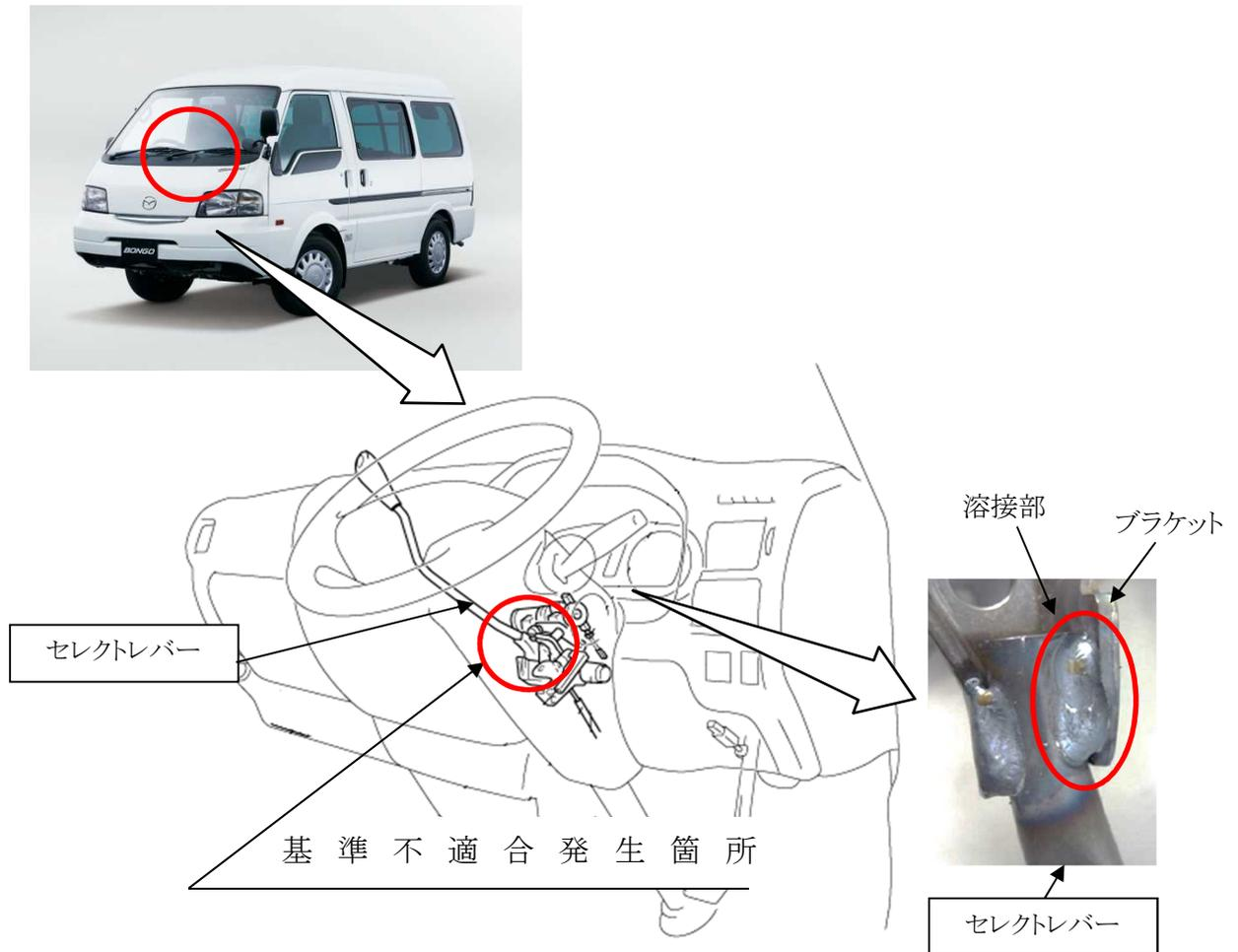
自動変速機のセレクトレバーにおいて、溶接設備の設定が不適切なため、セレクトレバーとブラケットの溶接が不十分なものがある。そのため、セレクトレバー操作により溶接部が破断し、操作できなくなるおそれがある。
