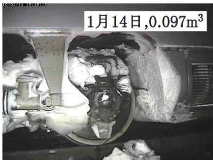
こまち車両の台車部側面の着雪量とカメラ画像の例
