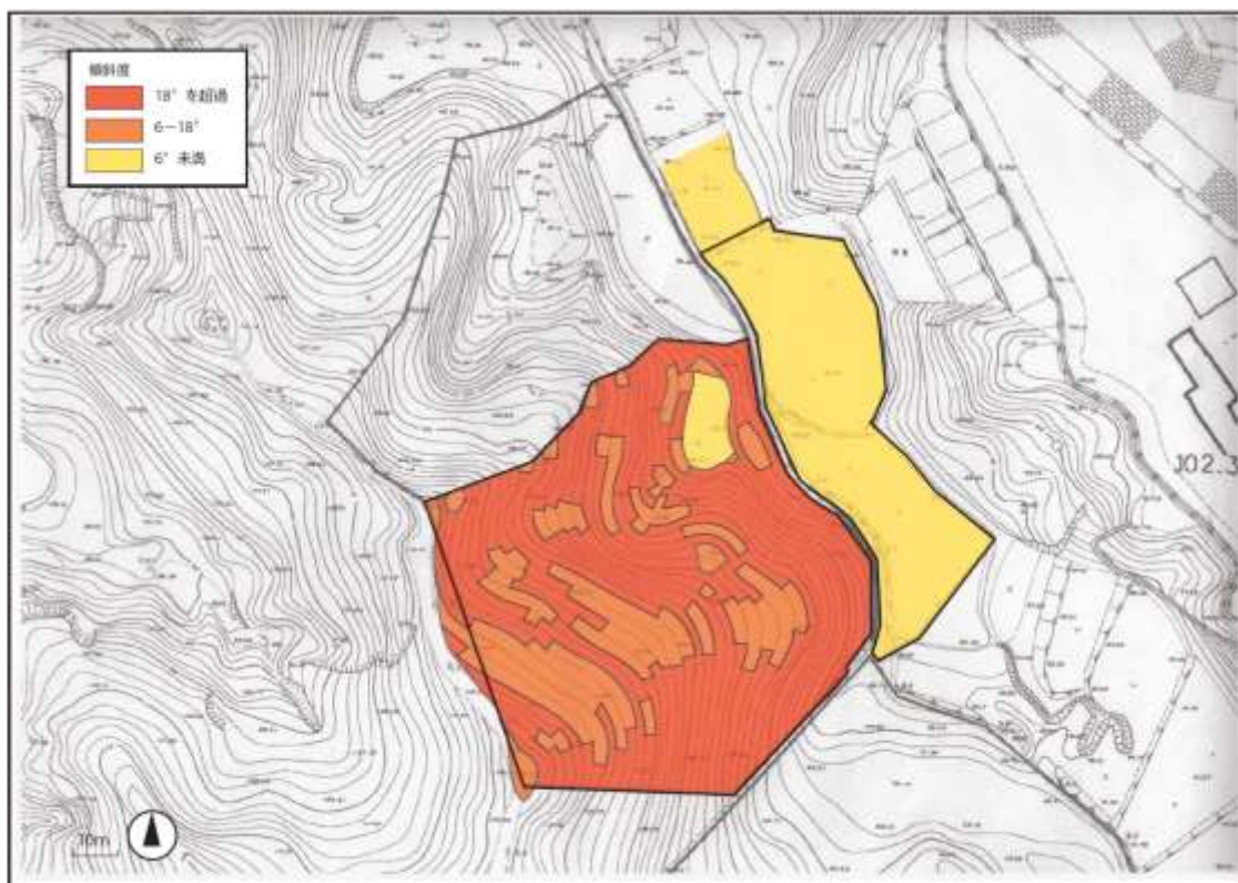
図 3-26 傾斜度<榑平田タイル>
