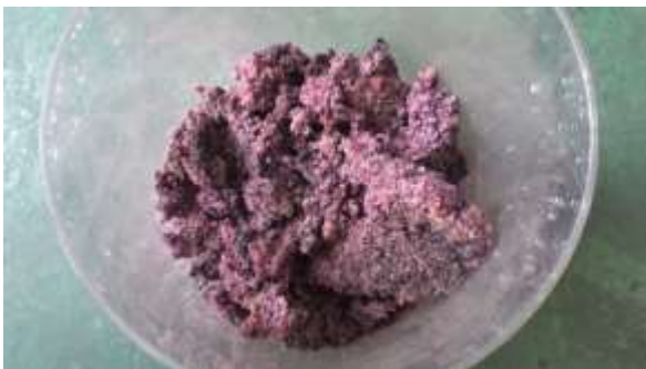
発生したクリンカ
