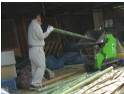
3. チッパー（樹木破碎機 GS121G 大橋）への投入
