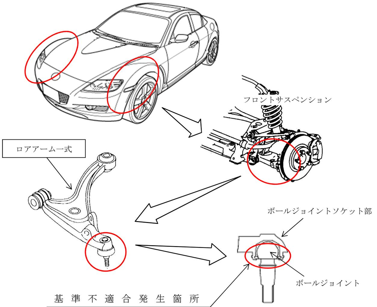
フロントサスペンションにおいて、ロアアームのボールジョイントの製造工程が不適切なため、ボールジョイントソケット部に亀裂が発生しているものがある。そのため、走行中に大きな衝撃が加わると、ボールジョイントソケット部からボールジョイントが外れ、最悪の場合、走行不能になるおそれがある。
