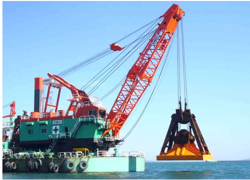
写真-1 新型グラブの搭載状況
