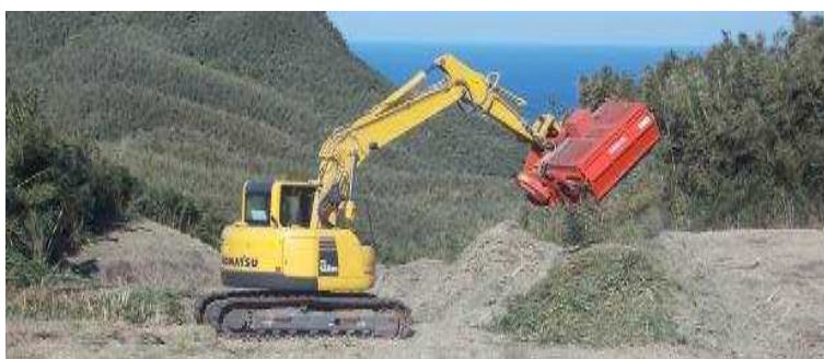
写真-3 バックホウ (0.45 m 3 ) へのブッシュチョッパー&アースシェーバー装着状況
