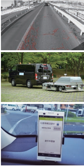
写真は現在提供中の各社のサービス。(上)「舗装ひび割れ自動解析サービス」(東芝)、(中)チャープレーダを用いた「路面下空洞探査サービス」(川崎地質)、(下)「道路パトロール支援サービス」でのスマホ画面 (FT RD)
