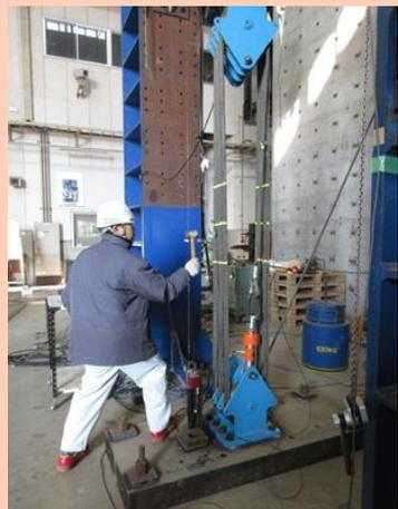
打診検査による振動数測定
