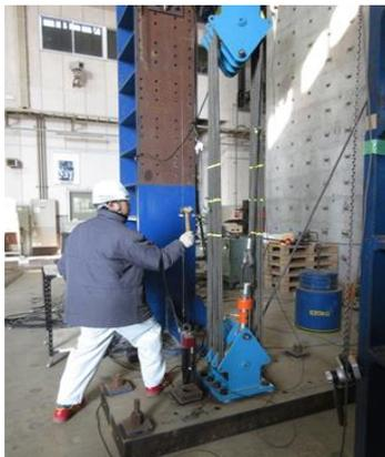
図5 打診検査による振動数測定
