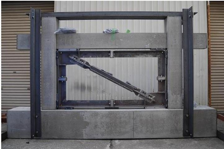
RC構造への適用構法
