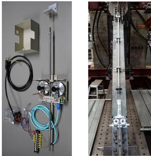
(a) 簡易センサー本体 (b) 試験体への設置状況
