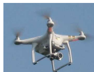
UAV(ドローン等)による3次元測量
