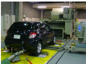
自動車排出ガス試験(台上試験)
