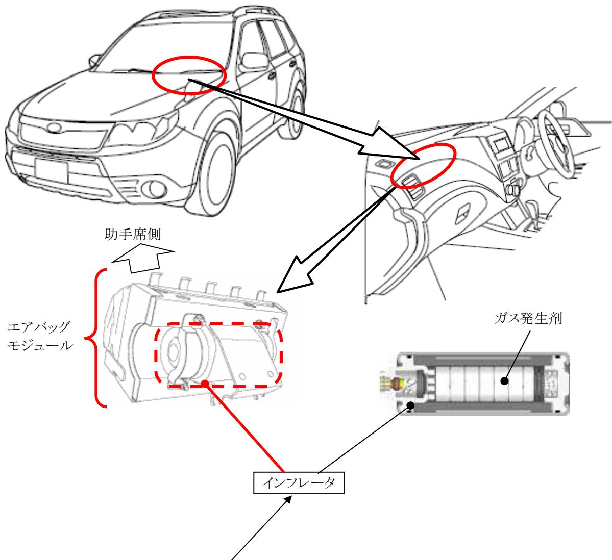
助手席用エアバッグのインフレータ(膨張装置)において、ガス発生剤の吸湿防止が不適切なため、温度および湿度変化の繰り返しによりガス発生剤が劣化することがある。このため、エアバッグ展開時にインフレータ容器が破損するおそれがある。
