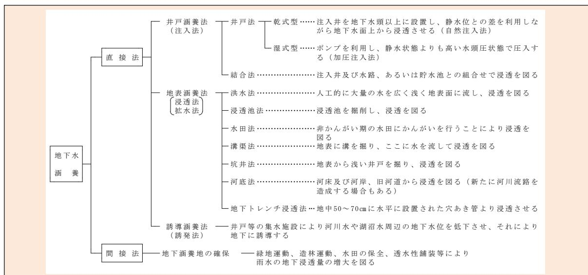
図3-2-1 地下水涵養の工法別体系
