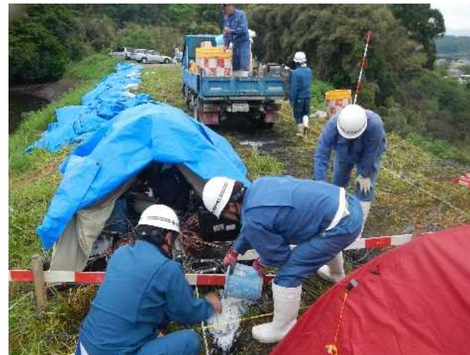
電気探査による亀裂深調査
