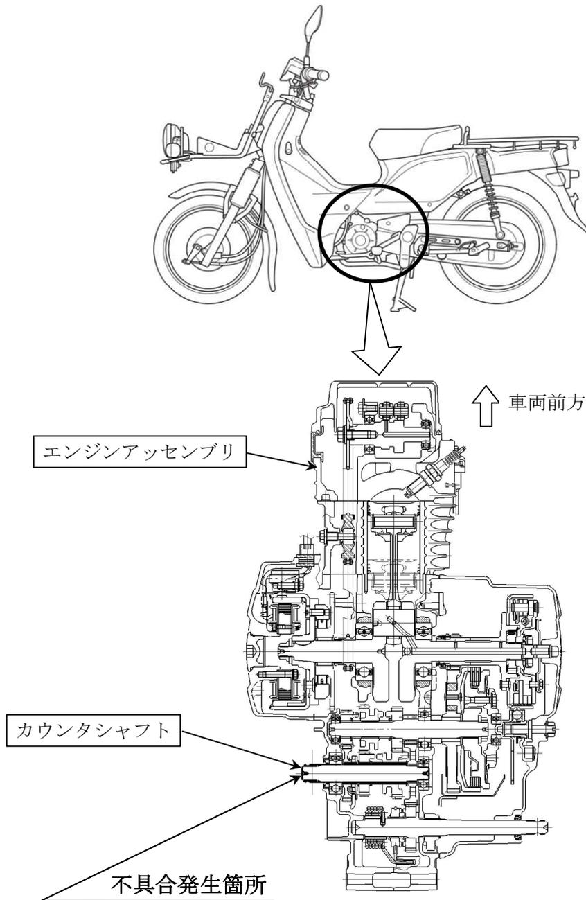
カウンタシャフトにおいて、熱処理後の歪み矯正処理が不適切なため、微細な亀裂が発生しているものがある。そのため、高い速度で急激なシフトダウンを繰り返すと当該シャフトの亀裂が進展し、折損して走行不能となり、最悪の場合、後輪がロックするおそれがある。
