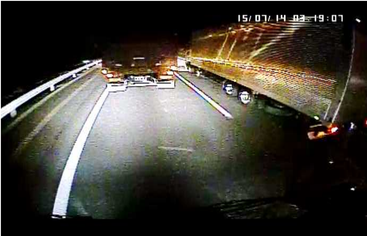
写真5—① (衝突約1.2秒前:衝突被害軽減ブレーキの制動開始信号発生地点)
