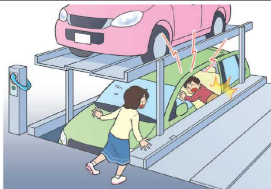
イラスト2 ボタン押し補助器具の使用と装置内立ち入りが容易のために起きた死亡事故例
