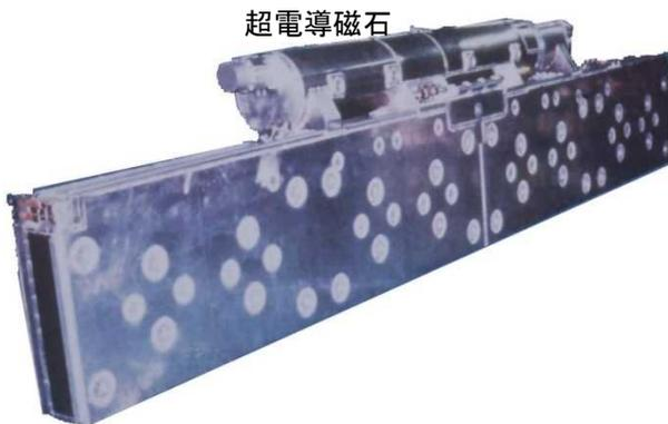
現在の超電導磁石 ( $-269^{\circ}\text{C}$  まで冷却)
