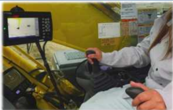
建機内のガイダンスモニターを見ながら作業する技術者
