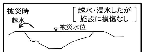
堤防の損傷はなかったが、越水・浸水したことから、河道拡幅等を実施
