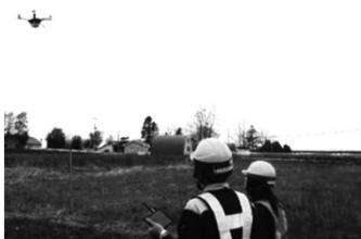
UAV（ドローン）を活用した測量
