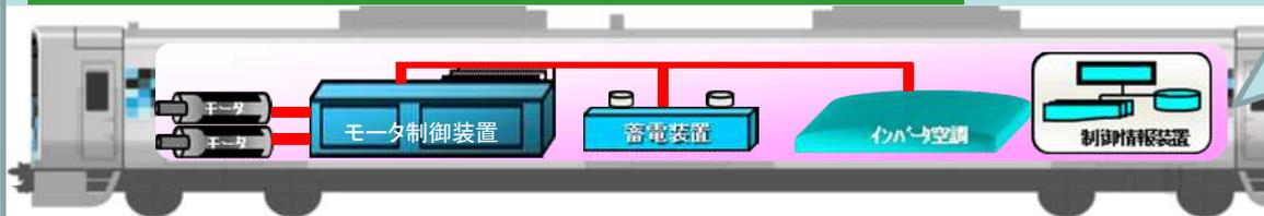
・回生ブレーキにより発電した電力の蓄電や、走行状態に応じた電力使用により、効率性の高いシステムを実現。
