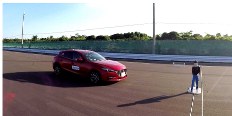
<予防安全性能評価>試験の例 ～対歩行者自動ブレーキ試験～
