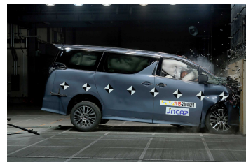
<衝突安全性能評価>試験の例 ～フルラップ前面衝突試験～
